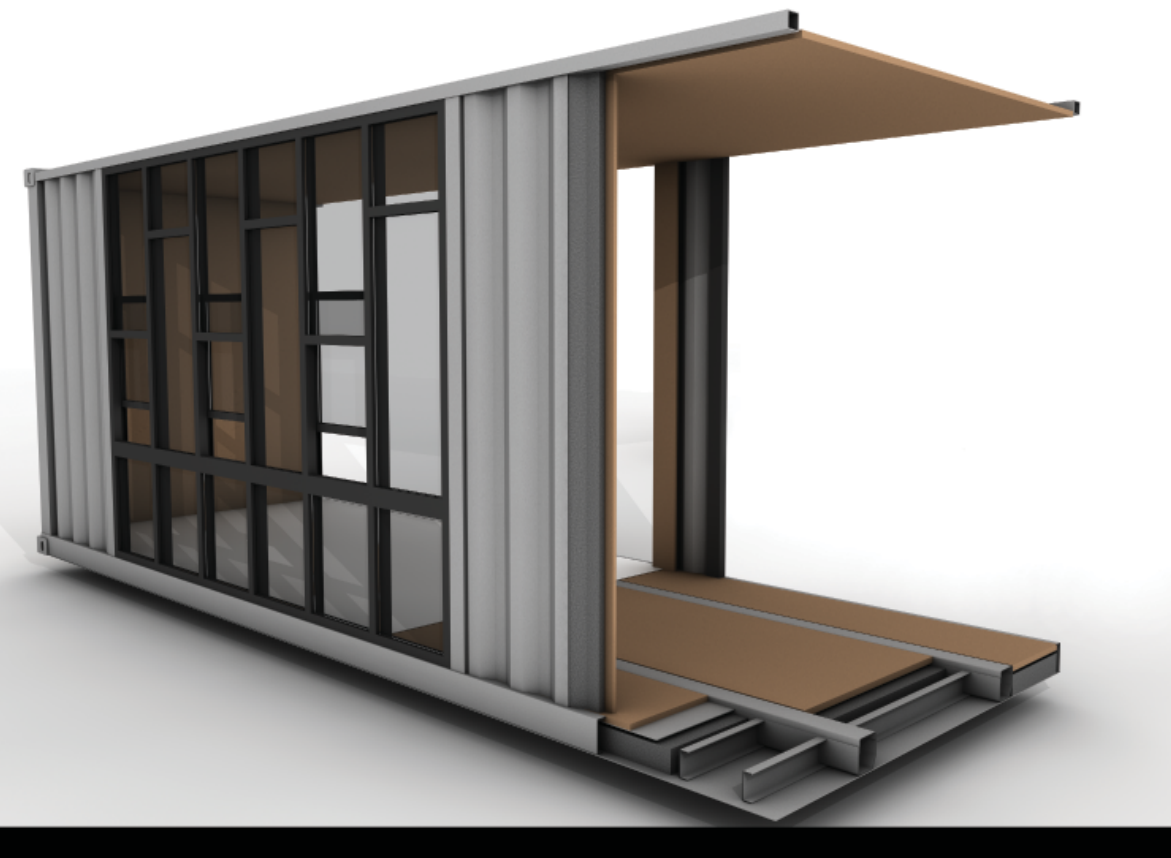
Παρεμβάσεις στο container | Ανοίγματα, κουφώματα, μονώσεις, εσωτερικές επικαλύψεις
