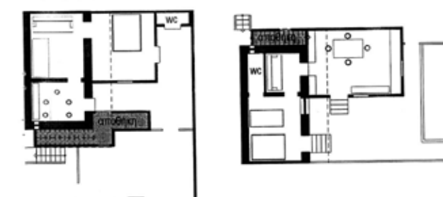
σχέδιο 31δ Η περιτομή του χώρου κάτω από τη σκάλα δημιουργεί αποθηκευτικούς χώρους
